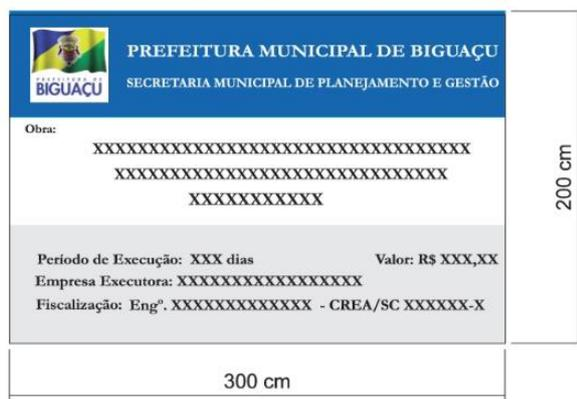
Diagrama de uma placa de obra retangular com dimensões de 300 cm de largura e 200 cm de altura. A placa é dividida em seções:
