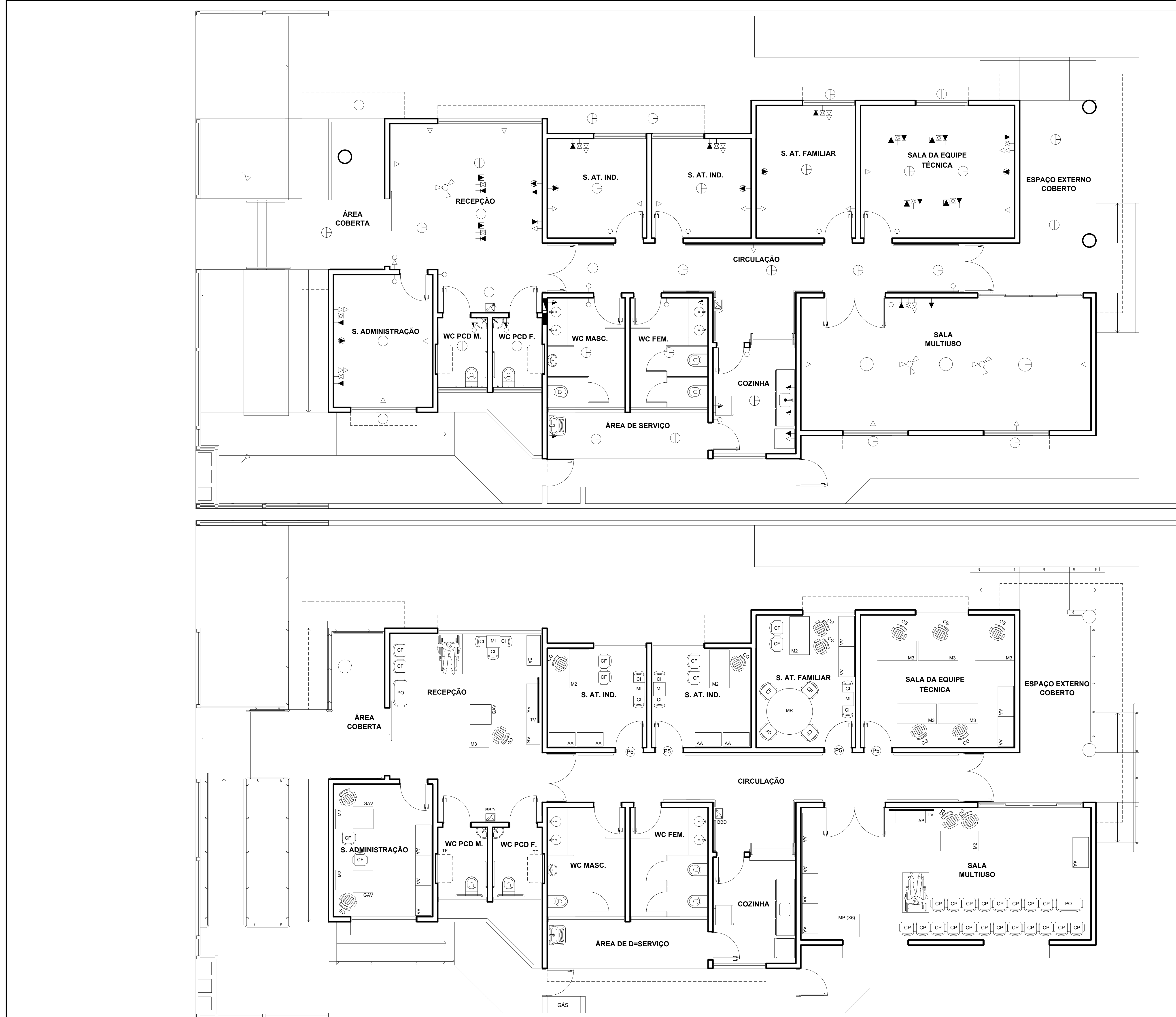
PLANTA DE LOCAÇÃO DOS PONTOS ELÉTRICOS ESCALA: 1:75
